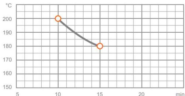
Пожалуйста, внимательно следите за параметрами отверждения, т.к. механические свойства проявляются при полном отверждении.
